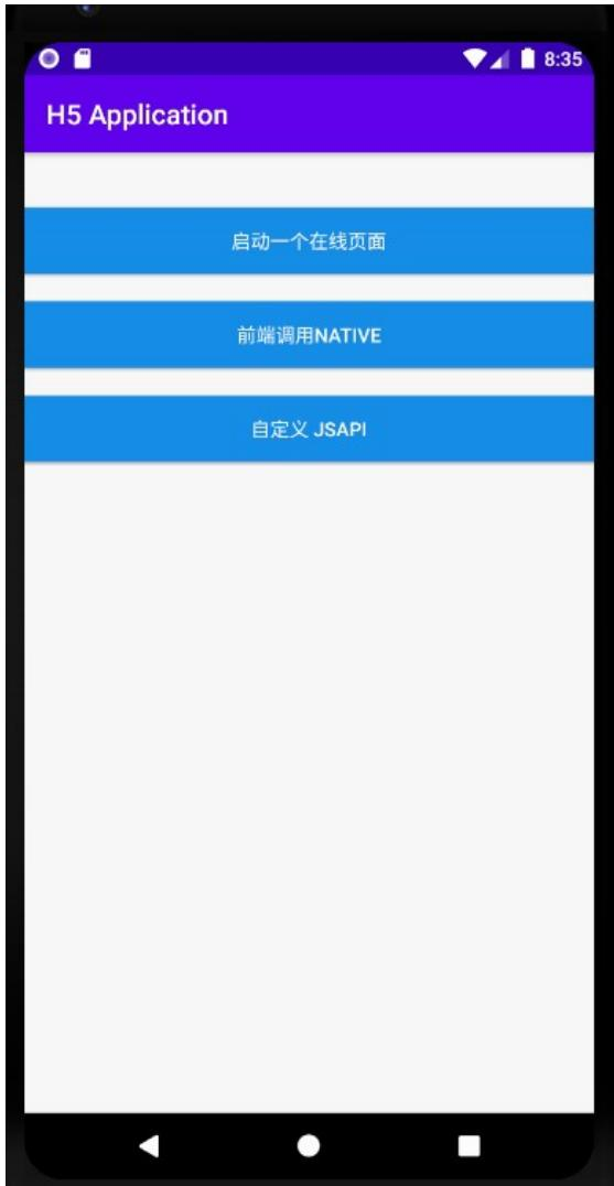
7. 单击按钮后即可打开前端页面，单击按钮 **自定义 JSAPI**，会打开包含了一个按钮 **自定义 JSAPI** 的前端页面。单击该 **自定义 JSAPI** 按钮，会再弹出一个无标题警示框，内容按照自定义 API 定义的功能处理了的前端调用时传入的参数。至此，您已完成 **前端调用自定义 JSAPI 接口**。
