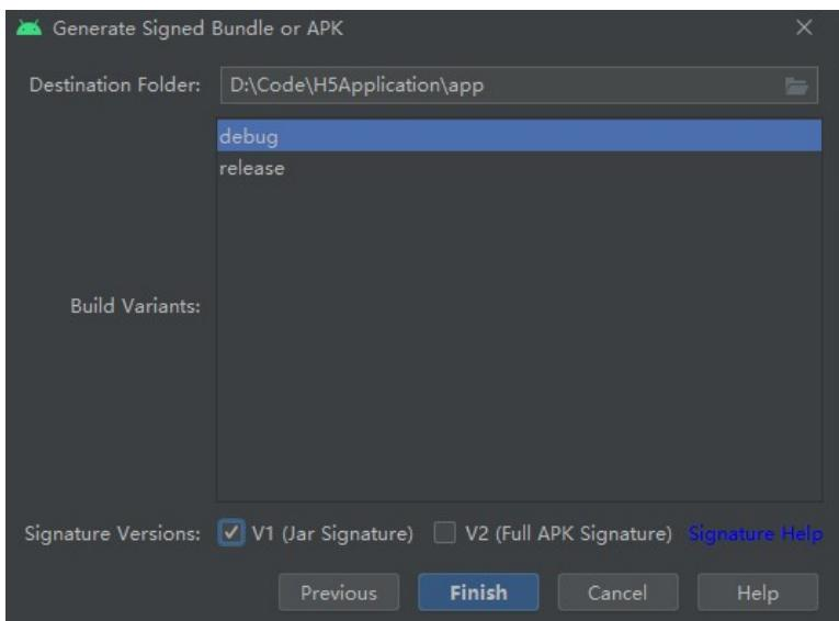
7. 点击 **Finish**。打包完成后在工程文件夹下的 `debug` 文件夹 (`~\MyHApplication\app\debug`) 中，即可获得该应用签名后的 APK 安装包。在本教程中，安装包名为 `app-debug.apk`。
